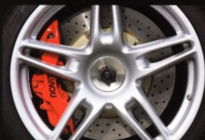
↑フロント8ピストンキャリパー、380mmセラミックディスクプレート、リア4ピストンキャリパー、そしてブレーキパッドがセットのハイパフォーマンスブレーキシステムを装備
