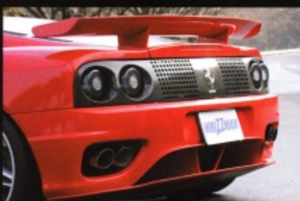
↑リアウイングは角度2段階の調整が可能。リヤスカートは純正バンパーに装着するタイプとなる。マフラーはステンレス製の90φ×2の左右出し。出口のみの交換も可能
