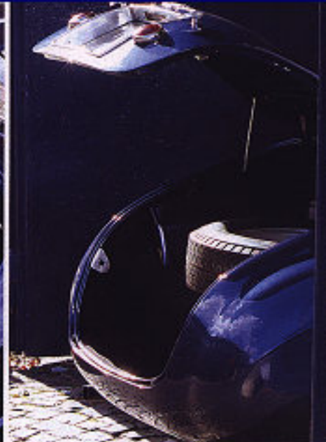
Da dieser Ferrari als Export mit gerader Chassisnummer für Rennen bestimmt war, fehlte ursprünglich der Tachometer. Im Kofferraum ist nur Platz für Tank und Reserverad. Die 15-Zoll-Borrans bieten genug Platz für riesige Leichtmetall-Bremstrommeln
