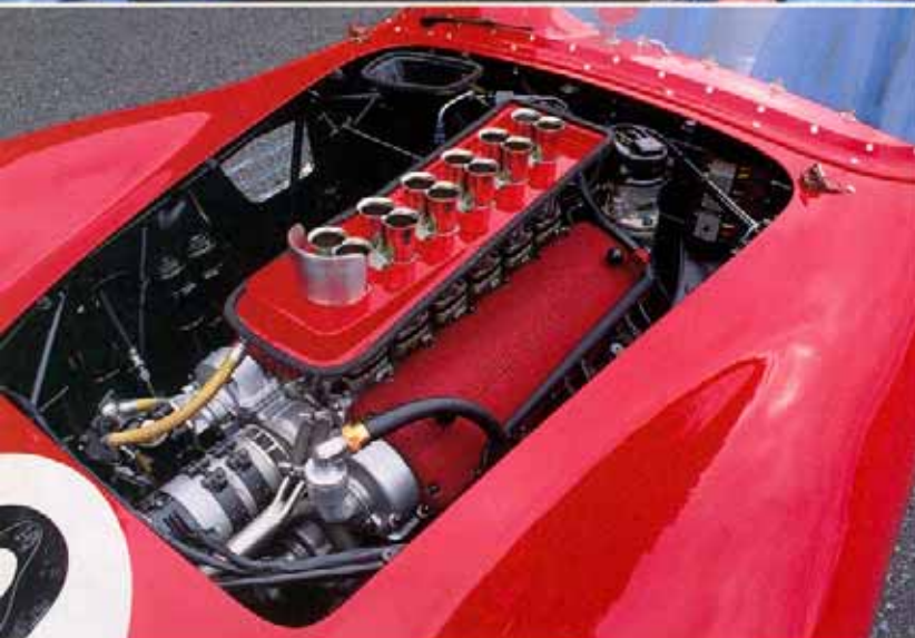
Dessinée par Pininfarina, la carrosserie de la TR59 était exécutée (avec soin) par Fantuzzi. Un événement car l'artisan modenais n'avait jusqu'alors travaillé que pour le rival Maserati. Le dessin de la boîte de vitesses en magnésium avait obligé à décaler le V12 de 10 cm sur la gauche. En haut à gauche : le papillon de roue scalpé, souvenir de Riverside, en 1959!
